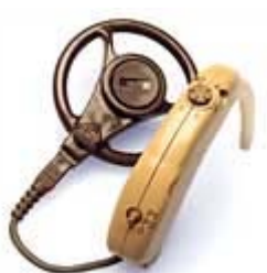
شکل ۵: واحد قرار گیرنده در پشت گوش به همراه سیم پیچ انتقال
