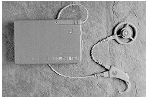
شکل ۶: بخشهای بیرونی تشکیل دهنده کاشت حلزونی
