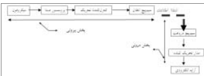
► شکل (۵) بلوک دیاگرامی از اجزای تشکیل دهنده پروتز حلزون
