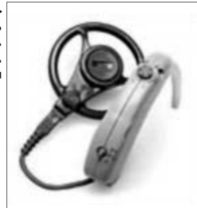
► شکل (۴) واحد قرار گیرنده در پشت گوش به همراه سیم پیچ انتقال
